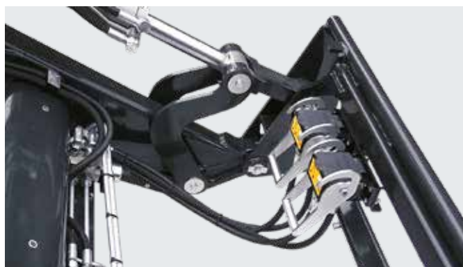
Per una connessione ancora più rapida, Tool Fix è disponibile anche per gli attrezzi terminali.
