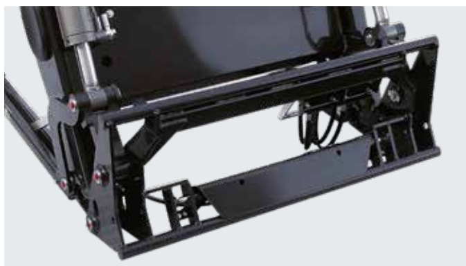
Dispositivo per il bloccaggio degli attrezzi con la pressione di un pulsante, cambio di attrezzo ancora più comodo, senza lasciare la cabina di guida – con HYDRO-LOCK.
